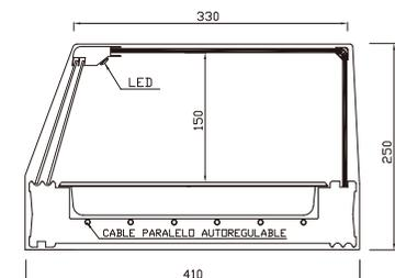
SISTEMA DE CALOR MEDIANTE
